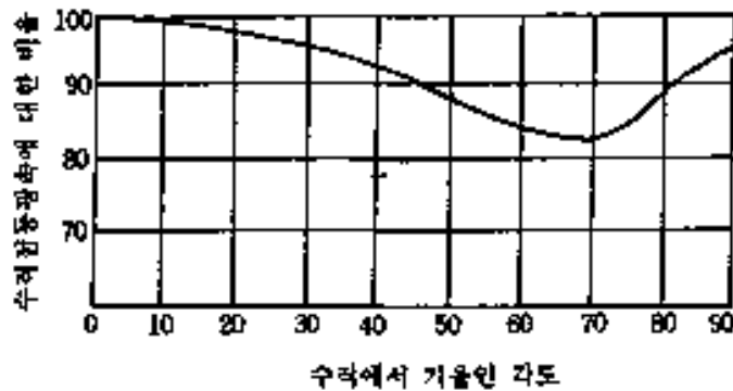
그림 2. HID램프의 점등 자세에 따른 광출력
